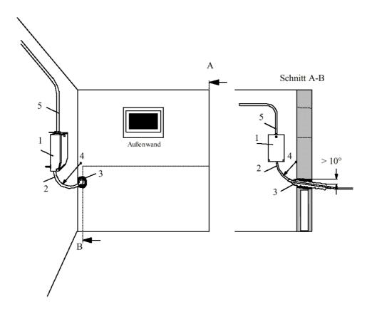
Bild 3: Anschluss mit Erdkabel
