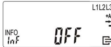
Um den erweiterten Datensatz auf der „INFO“-Schnittstelle dauerhaft zu aktivieren oder zu deaktivieren, schalten Sie durch Anblinken der optischen Taste die „INFO-Zeile“ solange weiter, bis **InF** mit dem aktuellen Status des erweiterten Datensatzes angezeigt wird:
