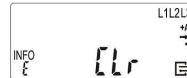
Um den Verbrauch innerhalb eines selbst gewählten Zeitraums zu ermitteln, schalten Sie mit der Taschenlampe die Anzeige solange weiter, bis in der „*INFO-Zeile*“ **E CLr** angezeigt wird. Leuchten Sie dann mit der Taschenlampe min. 5 Sekunden auf die optische Taste, bis die „*INFO-Zeile*“ **E CLr on** anzeigt. Ein weiteres Anleuchten für min. 5 Sekunden startet dann den gewählten Zeitraum.
